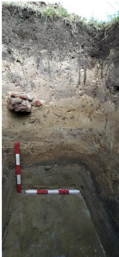
**Рис. 35. Зондаж № 4, фрагмент северного профиля, ниже среза породы с ненарушенной структурой, который состоял из плотного глиняного песка, присутствовали слои разнозернистого песка в слоистой структуре, ниже 190 см от поверхности присутствовали грунтовые воды. Фото П. Влизло**
