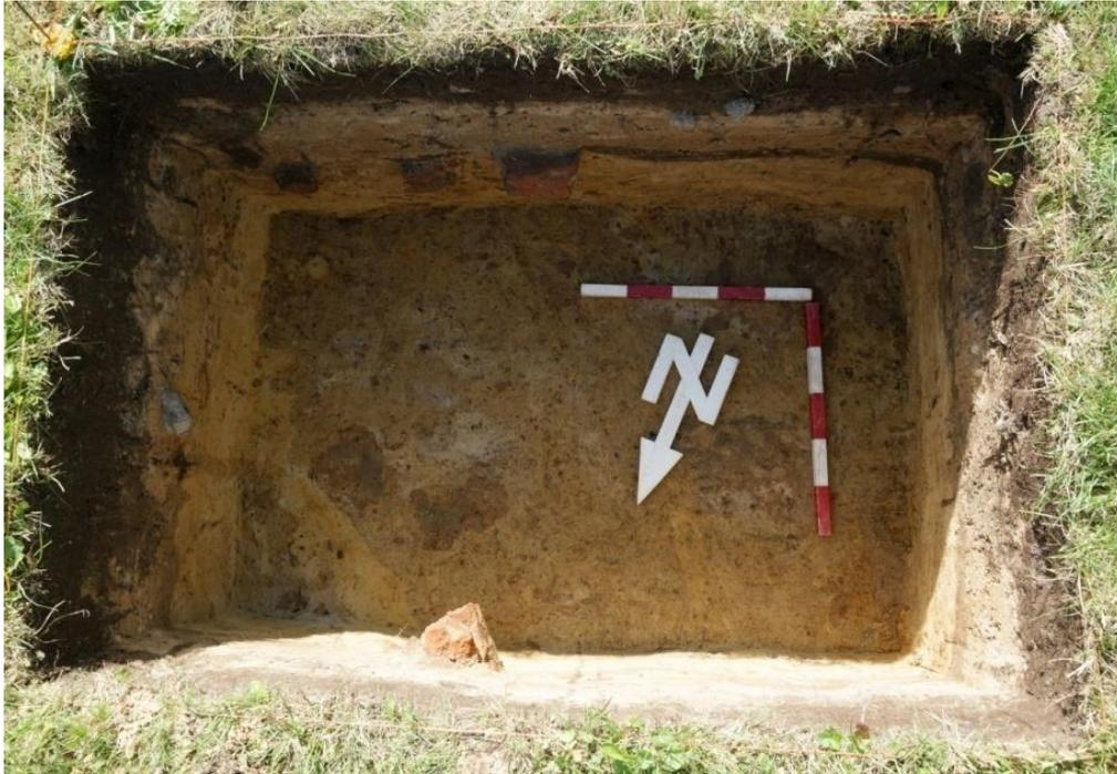
**Рис. 34. Зондаж № 4, вид на срез породы с ненарушенной структурой – плотный глинистый песок.
